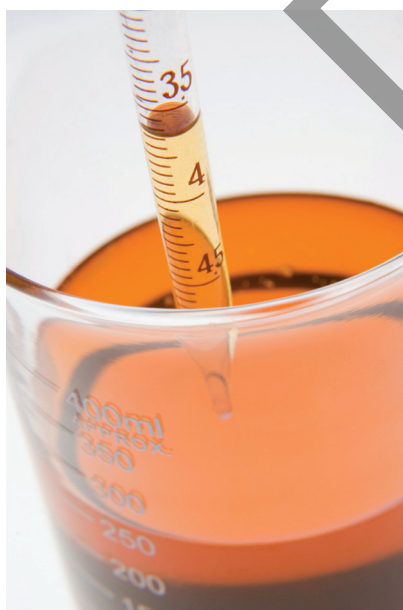
► Pipette scaled in ml ( \pm 0.5 ml)
